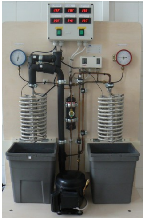
Obr.2 Laboratorní tepelné čerpadlo
