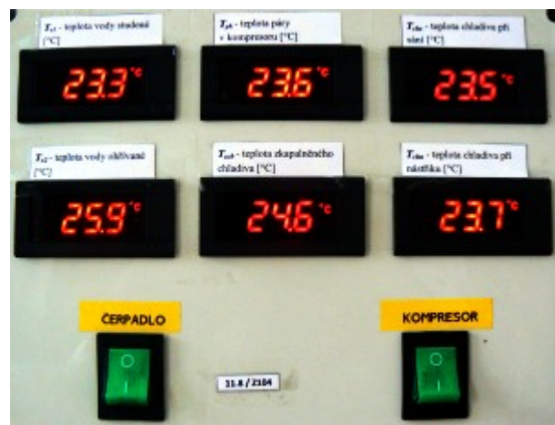
Obr.3 Ovládací panel pro zapnutí kompresoru a čerpadla pro rovnoměrné rozložení teploty v nádobě s vodou kondenzátoru (zobrazované teploty příslušejí různým částem tepelného čerpadla)
