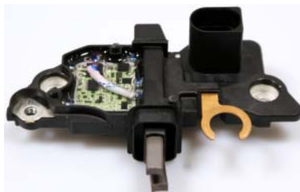
Obr.8 Regulátor Bosch F00M A45 209 BR14-TO se sejmutým krytem elektroniky
