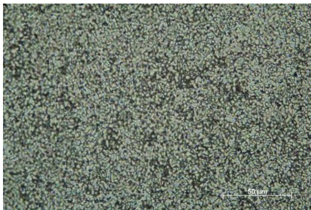
Obr, 5: Celkový pohled na mikrostrukturu experimentální PM oceli M390 realizovanou a interpretovanou s využitím LO mikroskopie
