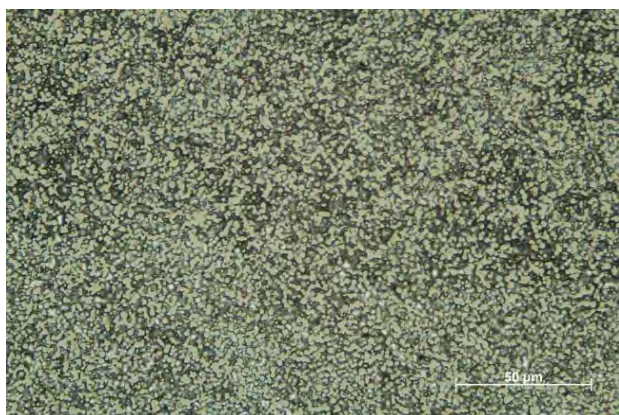
Obr, 6: Celkový pohled na mikrostrukturu experimentální PM oceli M398 realizovanou a interpretovanou s využitím LO mikroskopie
