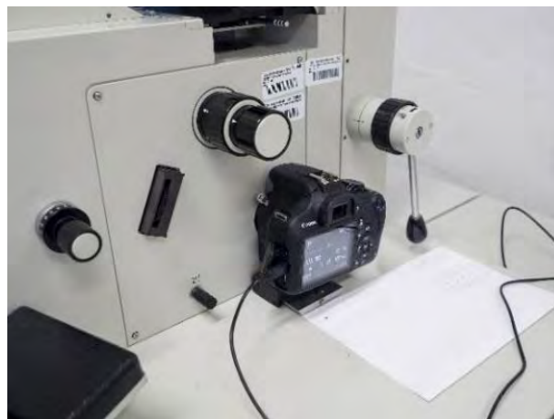
Obr. 4: Celkový pohled na část příslušenství použité LO mikroskopie reprezentovanou digitální kamerou Canon
