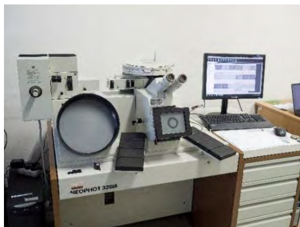
Obr. 3: Celkový pohled na světelný LO mikroskop NEOPHOT 32 s příslušenstvím
