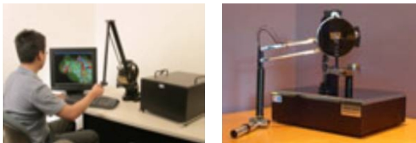
Obr. č. 1: Zařízení pro tvorbu silové zpětné vazby PHANToM
