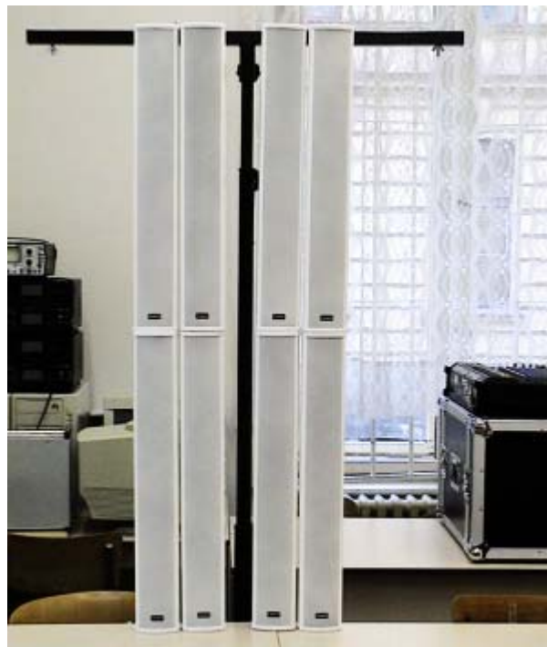
Obr.216 Laboratorní verze velké reproduktorové stěny 4 × 16 (8 × DPT208)
