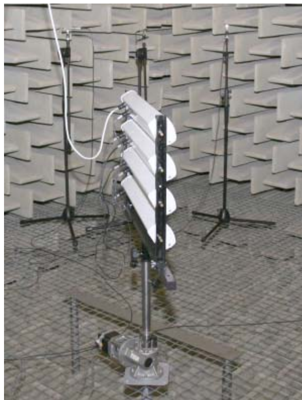
Obr.187 Reproduktorová stěna 4×DPT208 instalovaná na točně bezodrazové komoře
