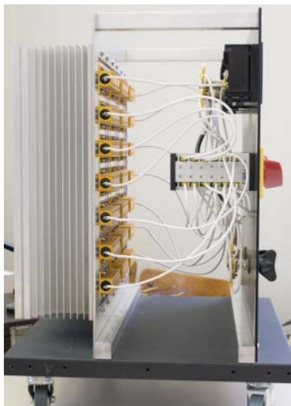
Obr.16 Bezindukční zátěž 210 A bez krytu (sady odporů, řadič QM1, vpravo dole rozdělovač proudu na výstupní svorce)
