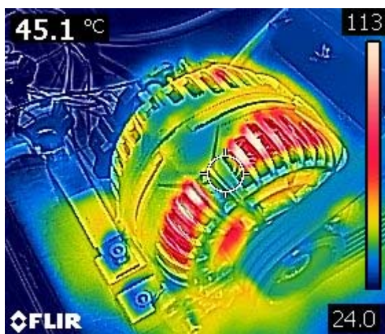
Obr.33 Termosnímek alternátoru zatíženého jmenovitým proudem 120 A
