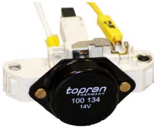
Obr.27 Pulzní regulátor Topran 100-134 14 V s připojenými spojovacími vodiči
