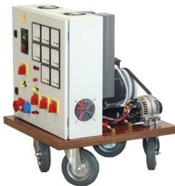
Obr.1 Měřicí soustrojí se středofrekvenčním synchronním alternátorem
