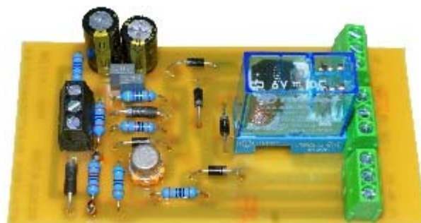
Obr.3 Osazená deska plošných spojů ověřovacího lineárního regulátoru
