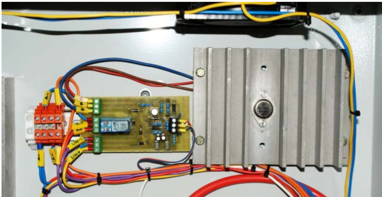
Obr.9 Lineární regulátor v rozvaděči měřicího soustrojí
