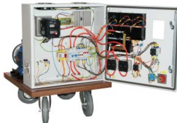
Obr.8 Otevřený rozvaděč soustrojí
