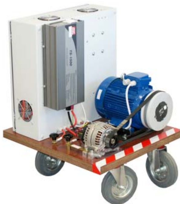
Obr.7 Měřicí soustrojí s novým motorem Celma-Indukta 2SIE112M6
