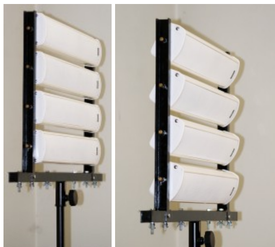
a) klasická 8x4 b) s vnucenou fázovou chybou Obr.135 Experimentální reproduktorové stěny
