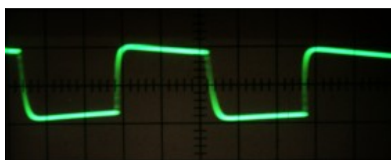
Obr.131b Signál na sekundární straně převodního transformátoru (odporová zátěž 16 \Omega )
