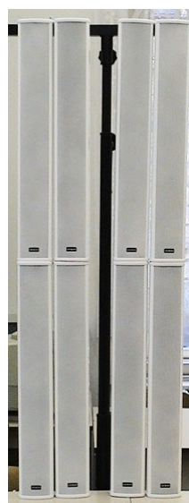
Obr.134 Reproduktorová stěna 4x16 8x DEXON DPT208 při montáži v laboratoři
