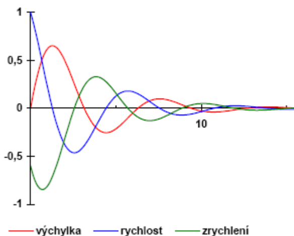
Obr.28 Hodnoty výchylky, rychlosti a zrychlení tlumených kmitů ( \delta = 0,3 )
