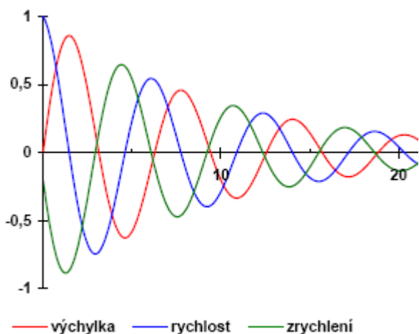
Obr.27 Hodnoty výchylky, rychlosti a zrychlení tlumených kmitů ( \delta = 0,1 )
