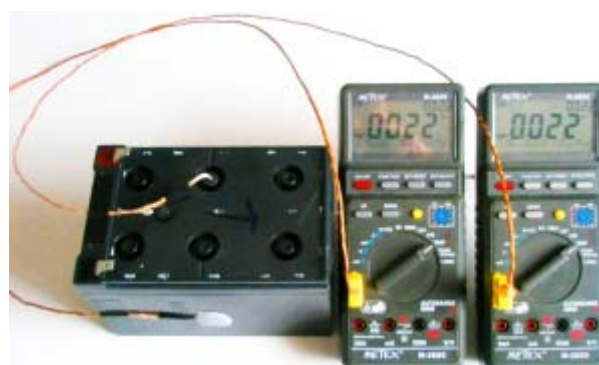
Obr.6 Akumulátor s digitálními multimetry Metex a termočlánky pro měření teplot
