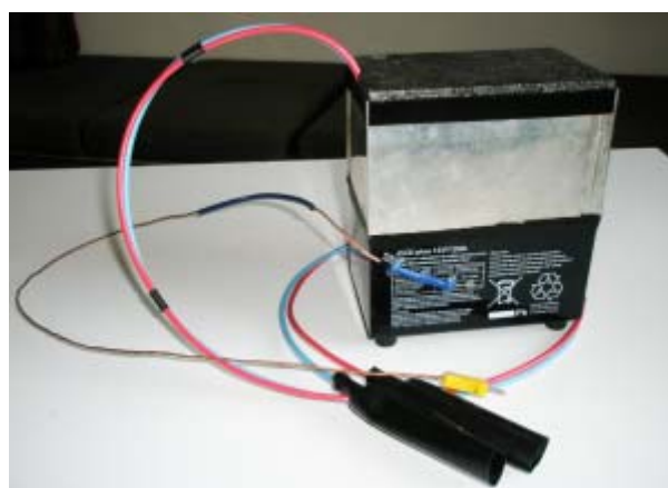
Obr.4 Akumulátor upravený pro měření ve vodní lázni
