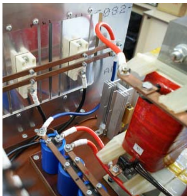
Obr.10 Propojení filtru v prototypu zdroje v pozadí na chladičích polomosty SKKD162
