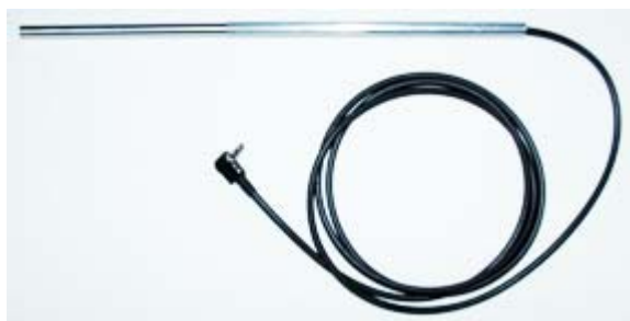
Obr.6 ECM senzor vestavěný do hliníkové trubičky s měřicím kabelem a konektorem
