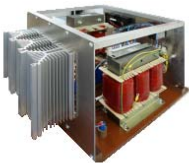
Obr.13 sestavený napájecí zdroj
