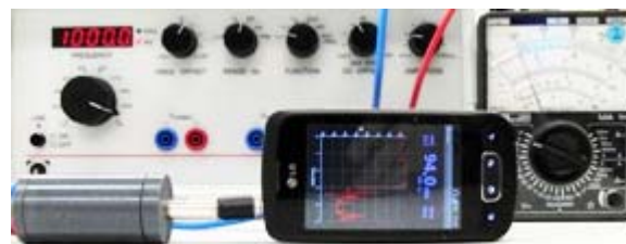
Obr.10 Kalibrace celého systému mobilního telefonu s externím senzorem a měřicí aplikací
