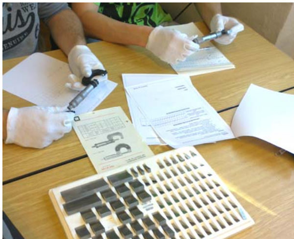
Obr.1 Kontrola presnosti mikrometra
