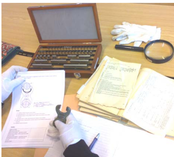
Obr.2 Kontrola strmeňového kalibru
