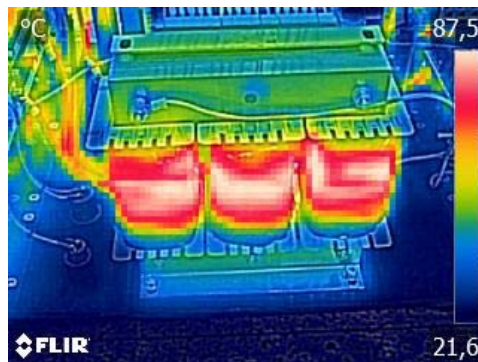
Obr.6 Transformátor TR1 (t = 60 min)
