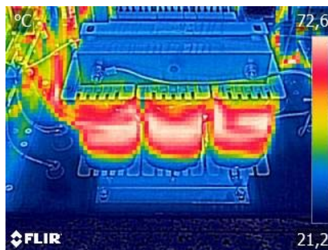
Obr.5 Transformátor TR1 (t = 30 min)
