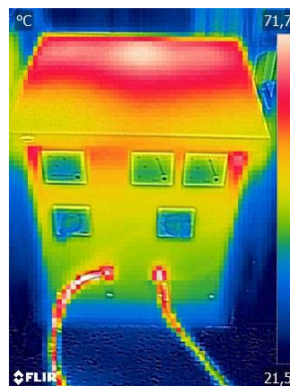
Obr.15 Termosnímek umělé zátěže (t = 60 min)
