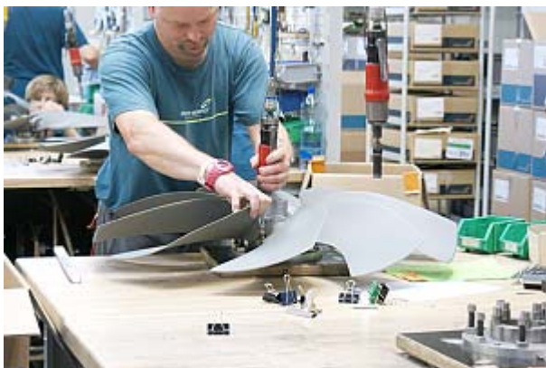
Obr.32 Montáž vrtulových listů
