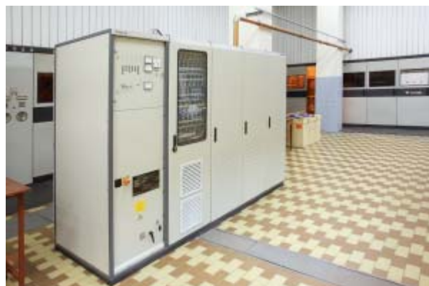
Obr.18 Tranzistorový vysílač TRAM 50L ve vysílacím sálu RKS Topolná [3]
