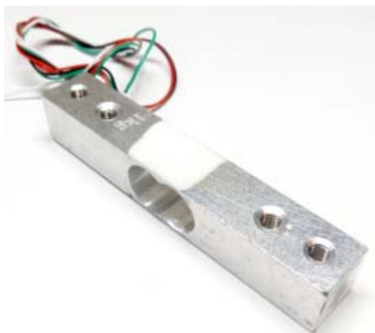
Obr.3 Hliníkový profil s tenzometrami
