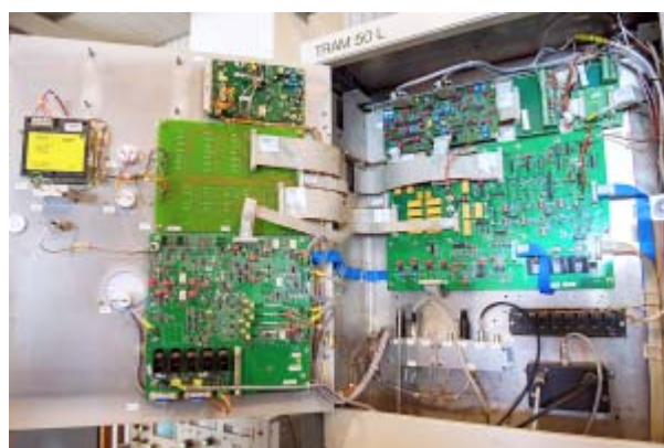
Obr.19 Řídící obvody tranzistorového 50kW vysílače TRAM 50L [3]
