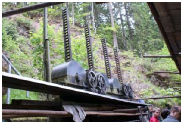
Obr.23 Mechanismus hlavních stavidel
