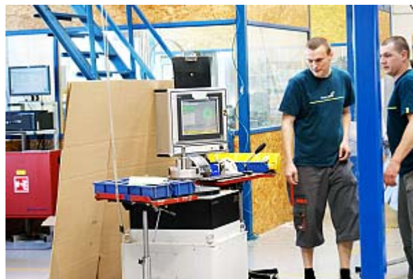
Obr.33 Vyvažovací pracoviště pro malé vrtule
