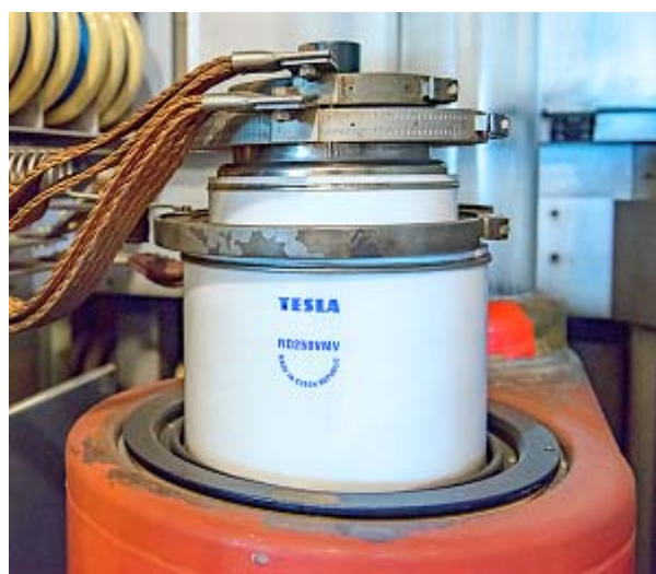
Obr.13 Výkonová trioda TESLA RD250VMV [3] žhavicí napětí 17 V, žhavicí proud 520 A, katoda z tyčí z thoriovaného wolframu, anodové napětí 10-13 kV, výkon 250 kW, chlazení anody varem vody
