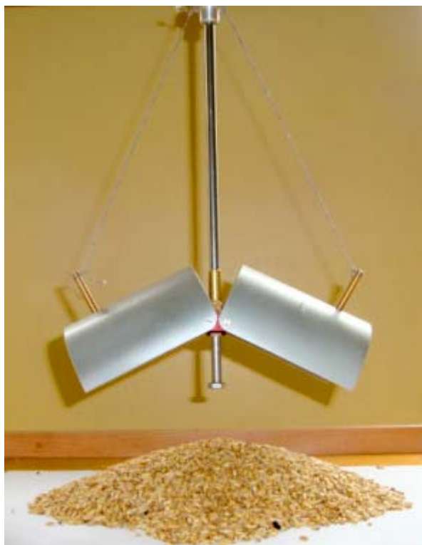
Obr.4 Zařízení na měření sesypného úhlu sypkých materiálů po výsypu
