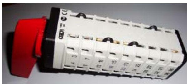
Obr.14 Sestavený radič VSR20-18004009-C8 (5 poloh, 9 pater, 36 vývodů, délka 14 cm)
