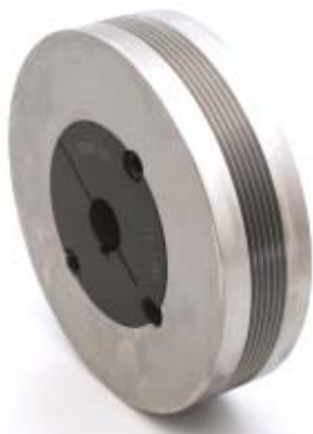
Obr.9 Drážková řemenice PK200-6 TB3020 s upínacím pouzdrem
