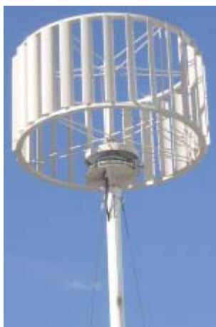
Obr.3 Oběžné kolo turbíny VAWT Seahawk s pomaloběžným diskovým generátorem [13]
