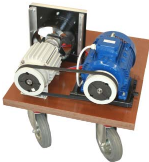
Obr.10 Sestavené soustrojí s ventilátorem na řemenici je zrcátko pro optický otáčkoměr
