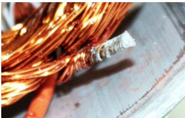
Obr.9 Detail spojení středu vinutí generátoru
