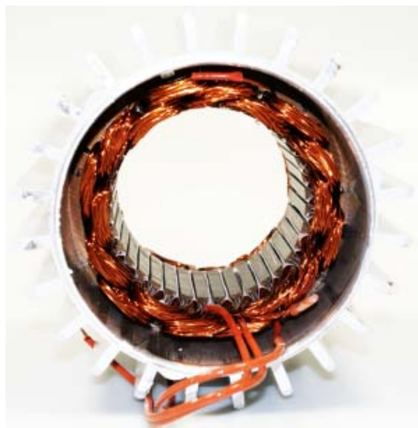
Obr.8 Stator NdFeB generátoru Ista Breeze
