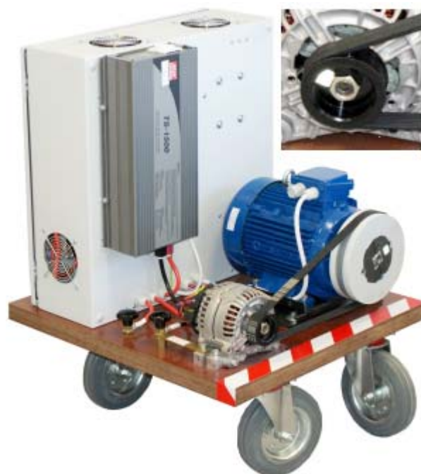
Obr.10 Zrcátko na hnací řemenici motoru, ve výřezu zrcátko uvnitř řemenice alternátoru
