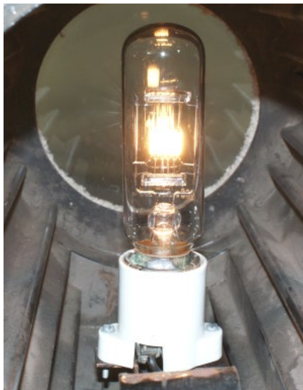
Obr.23 Lampová skříň 557 osazená patičí P28s s projekční žárovkou 220 V/1 000 W
