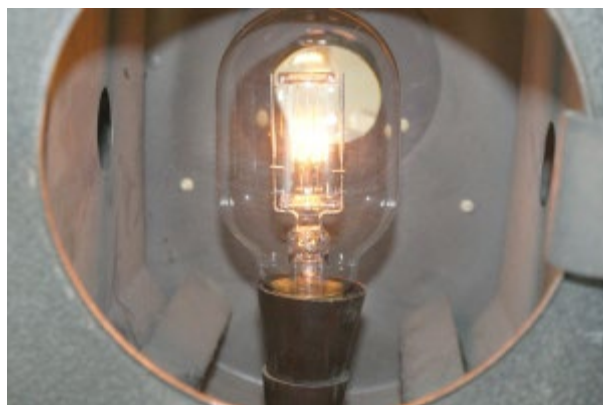
Obr.25 Originální osazení lampové skříně (žárovka Kino E27 120 V/500 W)
