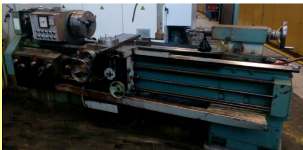
Obr. 3: Komplexný pohľad na sústruh SU 50A Rezné nástroje boli od spoločnosti SECO Tools CZ s.r.o. Celkovo bolo testovaných 8 typov karbidových vymeniteľných rezných platničiek (VRP) s geometriou C a W, obrázok 4, a rôznych utváračov triesok. V tabuľke 3 je prehľad označenia rezných nástrojov s VRP.
