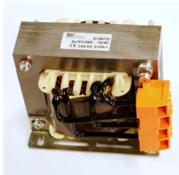
Obr.5 Kompenzační transformátor TR2 pro vývojový napájecí zdroj (BV elektronik Holice)
