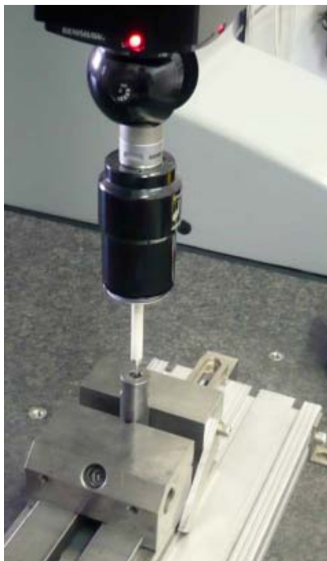
Obr.2 Meranie presnosti a kruhovitosti diery
