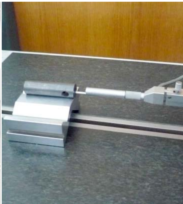
Obr.3 Meranie drsnosti povrchu
