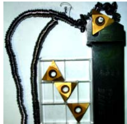
Obr.2 Sústruženie vnútorného lichobežníkového závitú na zvislom sústruhu SKIQ 16 CNC nástroj s VRP-SK-Z (WIDIA KRUPP), závitový a dokončovací nôž a tvar vznikajúcej triesky
