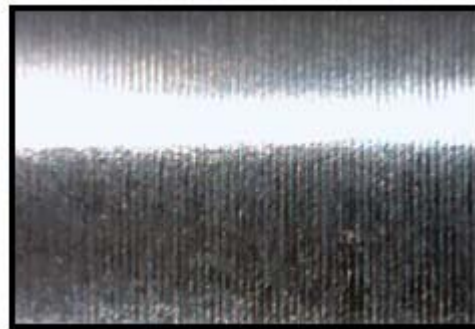
hladenie, R_a = 1,12 \mu\text{m} , zväčšené 60x
