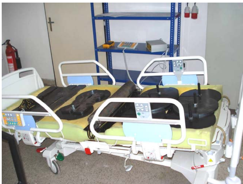
Obr.1 Nemocniční lůžko se zátěžovým systémem při zkoušce životnosti
