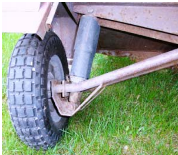
Obr.2 Pohled na uložení kola přívěsu
