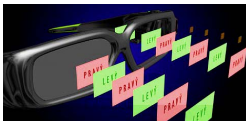
Obr.6 Princip aktivních 3D brýlí Depth-Q [1]
