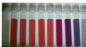
Obr. 198 Různé barevné roztoky podle velikosti a tvaru nanočástic zlata
