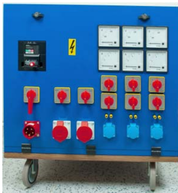
Obr.3 Ovládací panel rozvaděče RMG16
