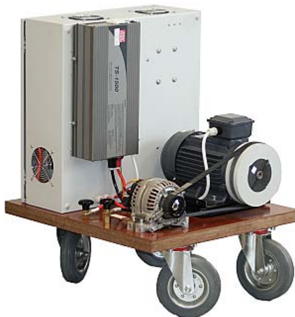
Obr.9 Střídač MW TS-1500-212B nainstalovaný na rozvaděči soustrojí
